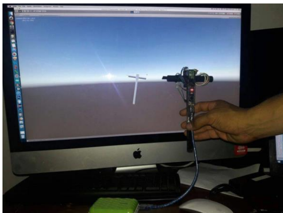
Figura 3. Prueba de protocolo de comunicación por bluetooth entre el mando embebido y el software 3d.
