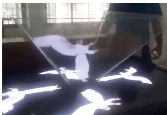
Figura 6. Cristal normal a 45^\circ con Video de ángel creado para hacer pruebas.
